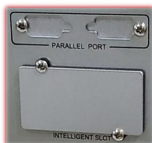
Slot para conexión Paralelo y SNMP.
