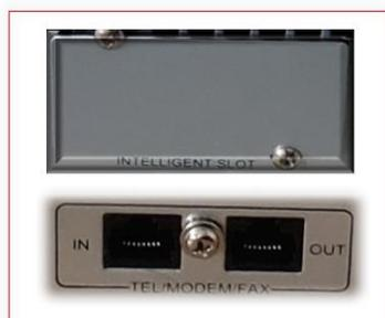
Slot para conexión SNMP y protección Modem.
